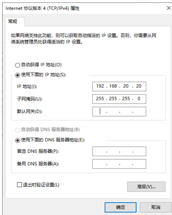
图 5-3 网络适配器 IP 配置
