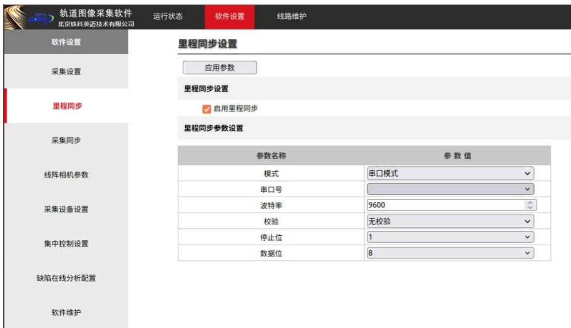
图 2.3-1 串口里程同步设置
