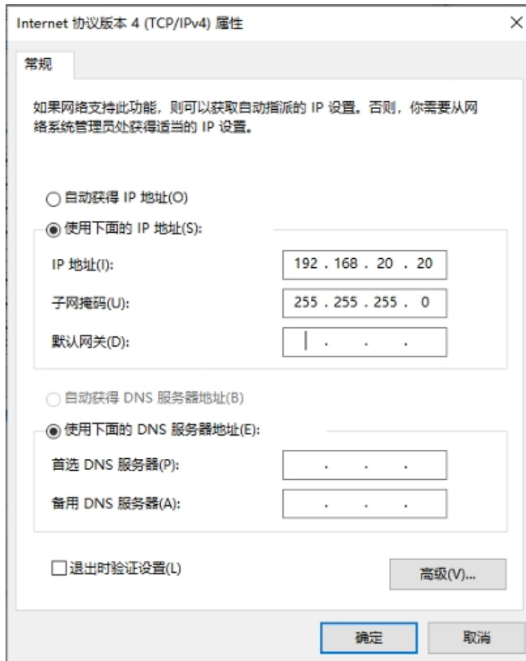
图 3.3-3 网络适配器 IP 配置
