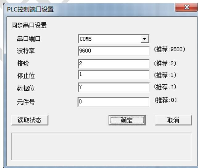
图 5 PLC 控制端口设置对话框
