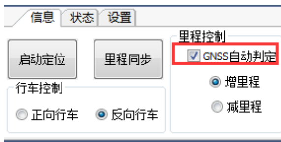
图 6-3 GNSS 自动判断增减里程
