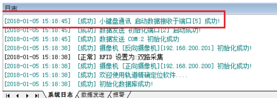
图 5-7 小键盘通信端口初始化成功
